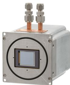
英国Raptor Photonics公司的Eagle XV相机是专门为真空特殊工作环境设计的，可以直接放置在真空腔室内使用。相机采用了Teledyne e2v公司的背照式CCD芯片，100%的填充因子，可直接探测从真空紫外（极紫外）到软X-ray波段（12eV–20keV能量范围）。
